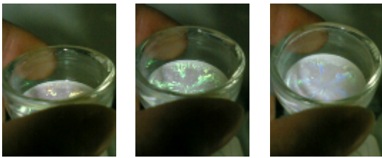
図 2: 作製したオパール(角度を変えて撮影)
