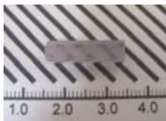
図2 作製したTi:LuAG単結晶。
